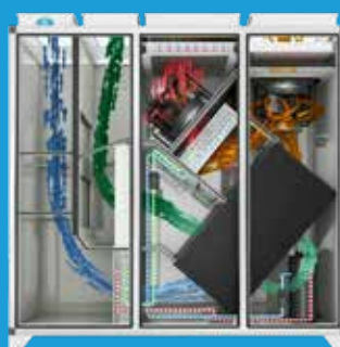
Betrieb mit hohem Umluftanteil
