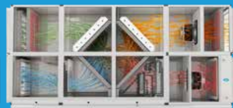
Betrieb mit 100 % Außenluft
