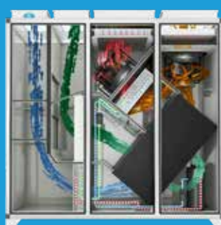
Betrieb mit hohem Umluftanteil
