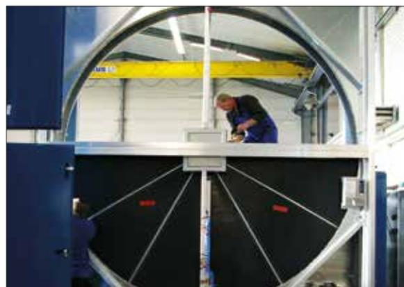
Rotoren werden vor allem für hohe Luftleistungen eingesetzt.
