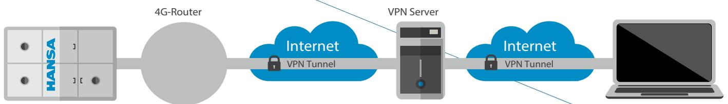
Über Router und VPN-Server werden die Daten sicher übertragen
