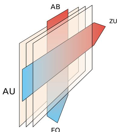
In einem Plattenwärmetauscher, hier Kreuzstrom, werden die Luftströme Abluft-Fortluft und Außenluft-Zuluft schichtweise durch Platten getrennt aneinander vorbei geführt.
