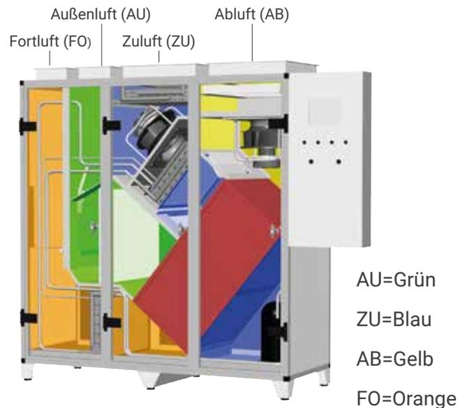
Kreuzstrom-Wärmetauscher ausgeführt als Doppelplattentauscher (rot) im HKG-P-iK Kompakt-Klimagerät. Die Luftarten sind im Gerät jeweils durch die Standardfarben gekennzeichnet.
