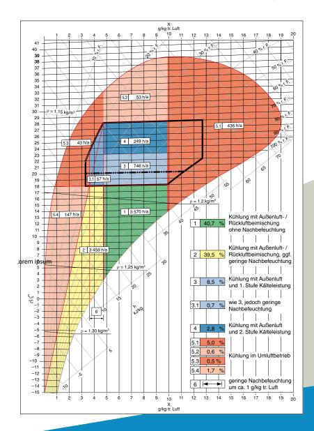
Im hx-Diagramm sind die für die Betriebsmodi relevanten Bereiche farblich unterlegt und durch die addierten Jahresstunden, die auf sie entfallen, und die Bereichsbezeichnung gekennzeichnet.
